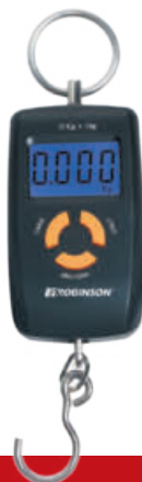
99-WA-025 Waga elektroniczna do 25 kg * jednostki pomiaru: kg, jin, lb, oz * dokładność pomiaru: 0-10 kg d=5 g, 10-25 kg d=10 g * zasilanie: baterie 2x AAA (w zestawie) - DODATKOWE FUNKCJE: * podświetlany ekran * czujnik temperatury * automatyczne wyłączenie * funkcja zerowania/ tarowania * wskaźnik niskiego poziomu baterii * wskaźnik przeciążenia
